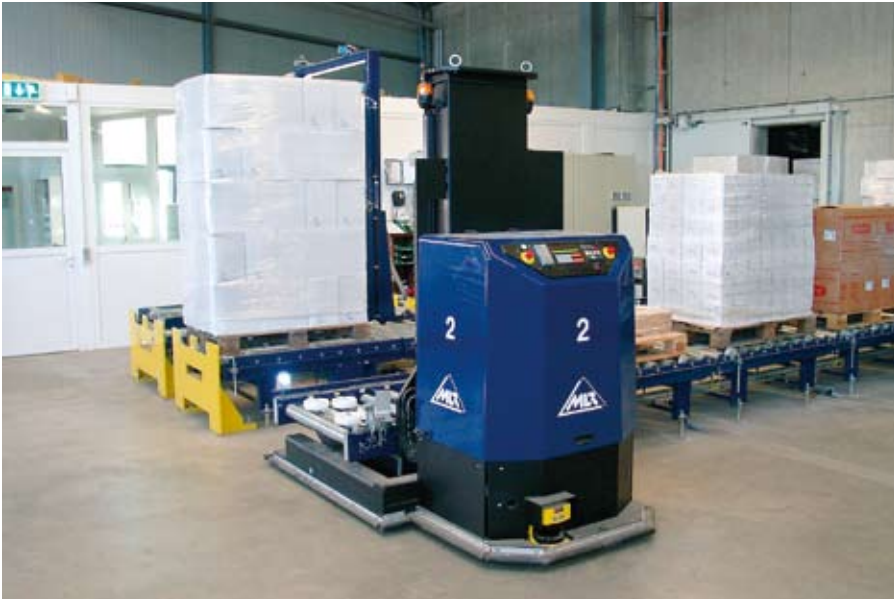
Abbildung 1: Vollautomatischer Wareneingang mit FTS
