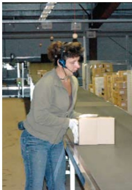
Abbildung 2: Kommissionierung mit Pick-by-Voice
