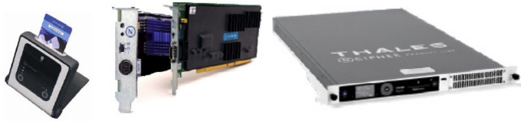
Abb. 2: Verschiedene Bauformen der Hardware Security Module
