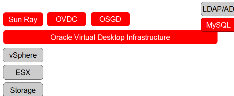
Abb. 4: Architekturübersicht Oracle VDI bei der AIDA Cruises.
