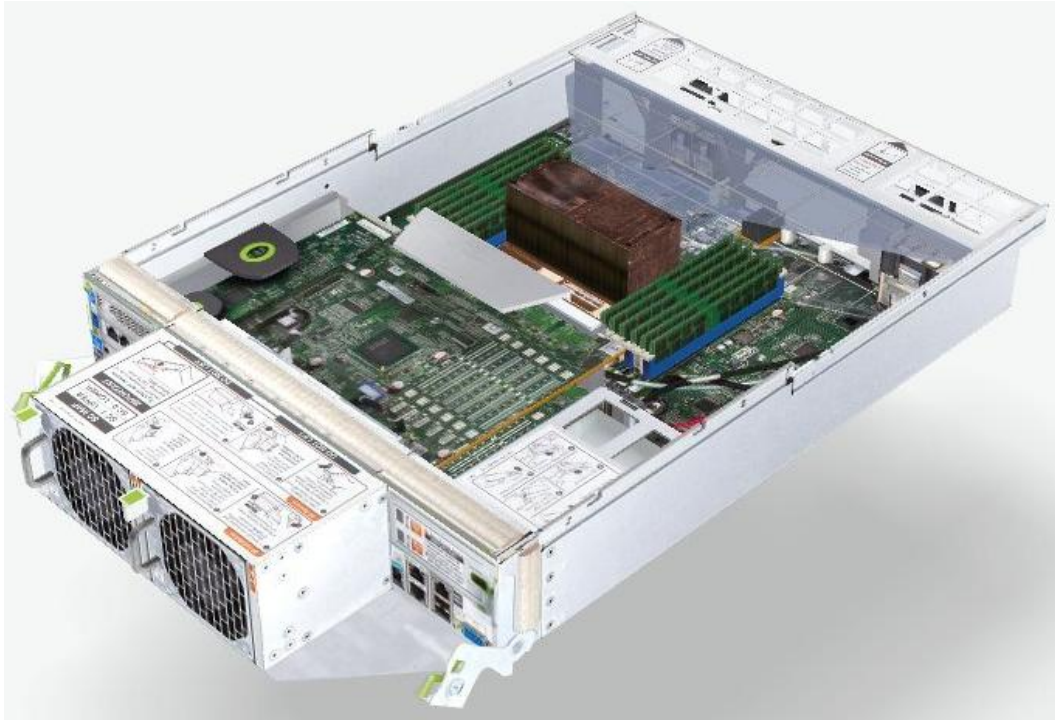
Abb. 3: Geöffneter Knoten der ODA (siehe Oracle Database Appliance 3D Demo: http://www.oracle.com/technetwork/server-storage/engineered-systems/database-appliance/overview/index.html?ssSourceSiteId=ocomen )
