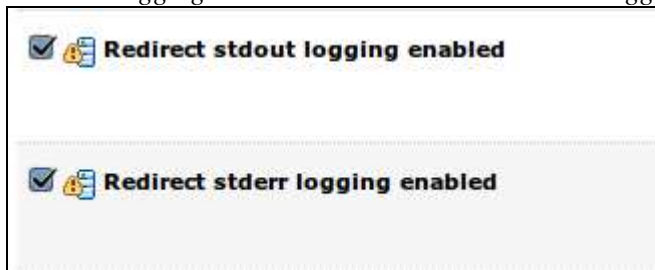
Abb. 1: WLS Server: Umleitung von stdout und stderr in Log-Dateien
