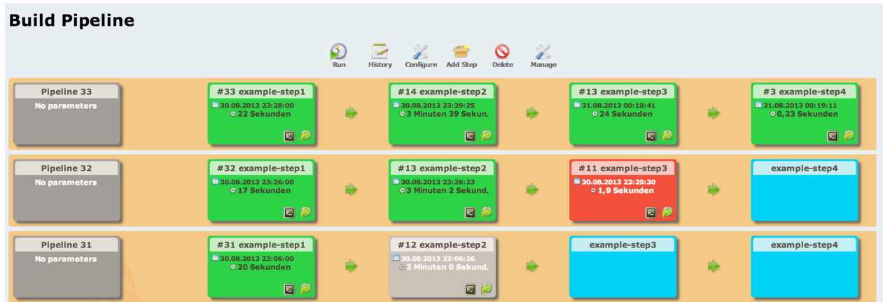
Abb. 4: Unsere Build Pipeline. Der letzte Build war vollständig erfolgreich, während im Build #32 der Test nicht erfolgreich war; daher wurde auch der folgende Schritt nicht mehr ausgeführt.
