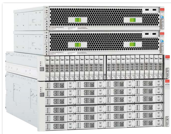
Abbildung 1: ZFS Storage Appliance ZS3-2 mit zwei Clustered Controller Heads, einem DE-24P Disk Shelf mit 24 2.5"-10.000rpm-900GB- und einem DE-24C Disk Shelf mit 24 3.5"-7200rpm-4TB-Laufwerken
