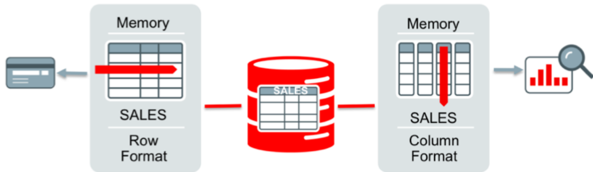
Abb. 2: Die Einbettung des Columnar Store der In-memory-Option in Oracles RDBMS
