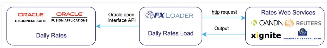
Abbildung 1: Zusammenfassung der FXLoader-Lösungen
