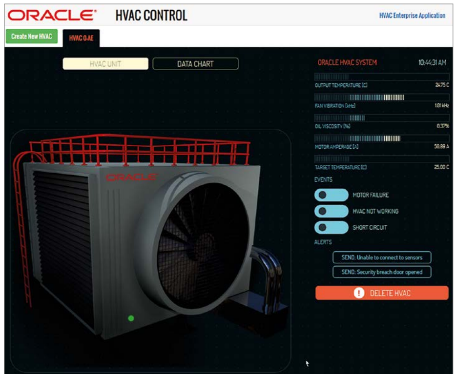
Abbildung 3: Simulation eines Klimageräts, das unter anderem Lüfter-Vibration, Öl-Viskosität, Motorstrom und Ausgangs-Temperatur als Beispieldaten an den IoT Cloud Service überträgt und verschiedene Fehler-Zustände simulieren kann
